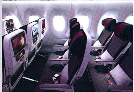
シート幅は17.2インチ(約43cm)、シートピッチは31インチ(約78.7cm)、10インチの個人モニターを設置。
